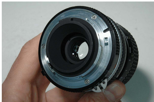
AIS met AI nok (op 8 uur) en in gevreesde sleuf op 3 uur.
