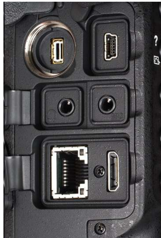
Nog een tip: monteer al deze aansluitingen op een aparte satelliet en breng daar ook een trekcontlasting op aan.
