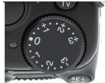
Lichtmeter correctie bedieningswiel.
